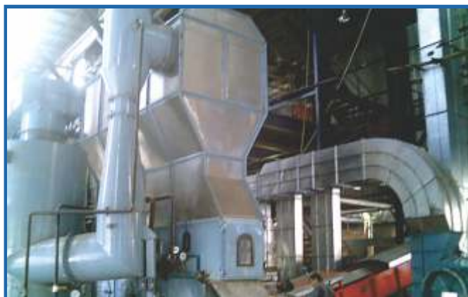
Cama Fluidizada de Secadora de Azúcar (Capacidad de 10 toneladas / hora a 60 toneladas / hora)
