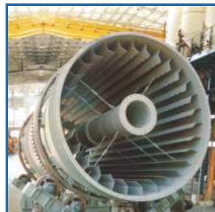
Secadora Rotativa de Azúcar (capacidad de 10 toneladas / hora a 60 toneladas / hora)
