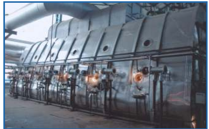
Tacho Continuo (Rango de capacidad 15 toneladas/hr a 150 toneladas/hr para alto y bajo grado de lava cocida)
